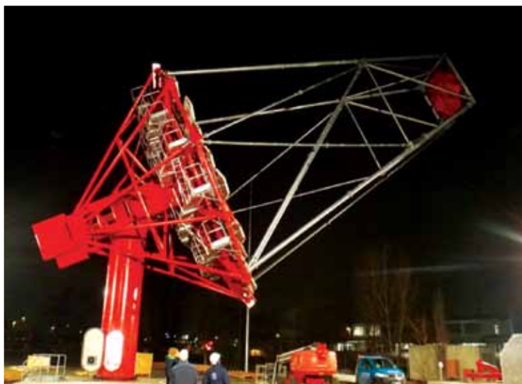
Montagem de como deverá ser o observatório CTA (acima). Protótipo do telescópio de 12 m (à esq.): estrutura criada no Brasil, formada por tubos prateados, conecta o espelho à câmera
