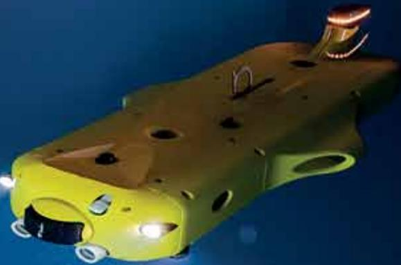
FlatFish: desenvolvido para verificar tubulações e plataformas no fundo do mar. Tem 2,20 m de comprimento e desce a 300 m de profundidade
