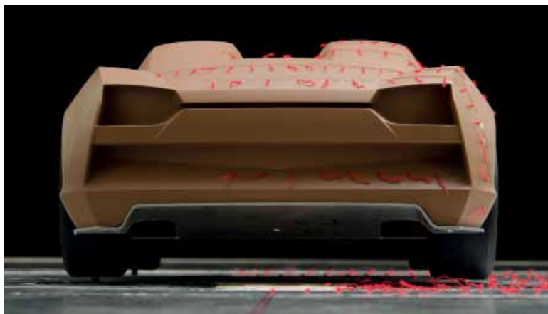
Modelo em escala reduzida do superesportivo da Electric Dreams: ensaios são realizados em túnel de vento
