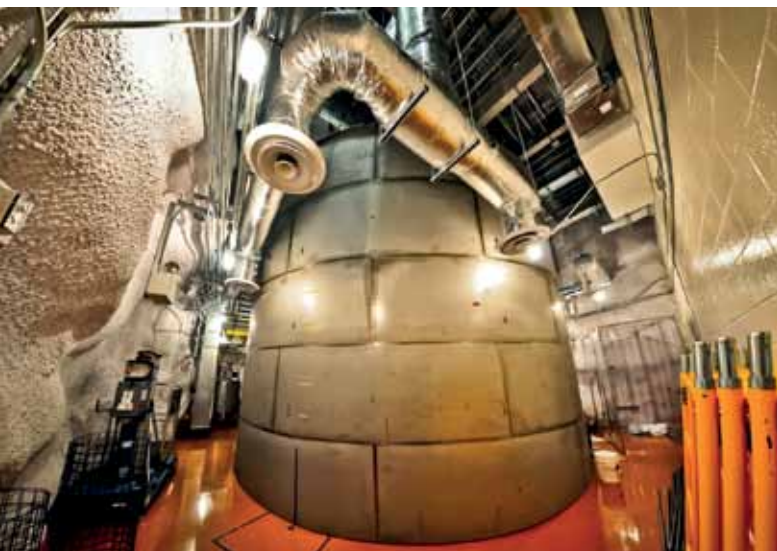
Tanque do experimento Lux, que usa detector com xenônio líquido para procurar pela matéria escura
