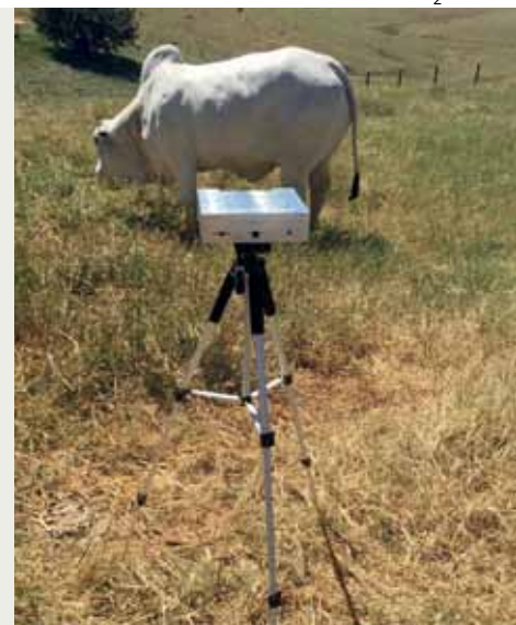
Sistema utiliza técnica de visão computacional para estimar o peso do gado
