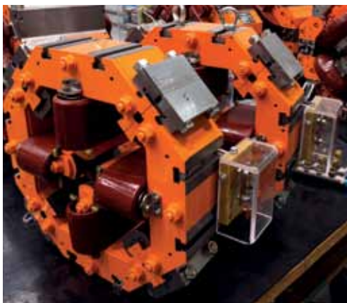
O engenheiro Rafael Seraphim realiza teste do sistema de vácuo das câmaras que conduzirão os elétrons. Ao lado, magnetos quadrupolos, um dos componentes do anel de armazenamento
