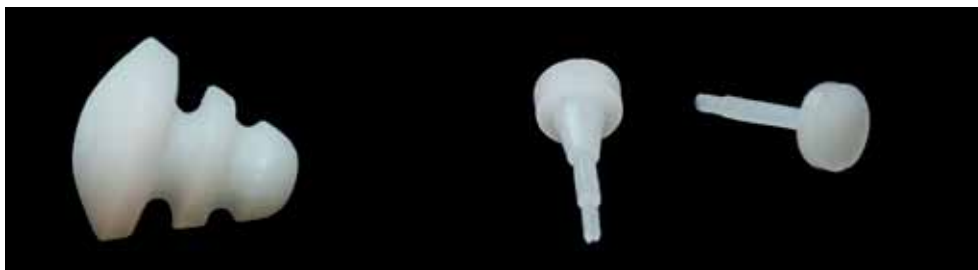
Material vitrocerâmico bioativo: implante ocular (à esq.) e ossículos do ouvido
