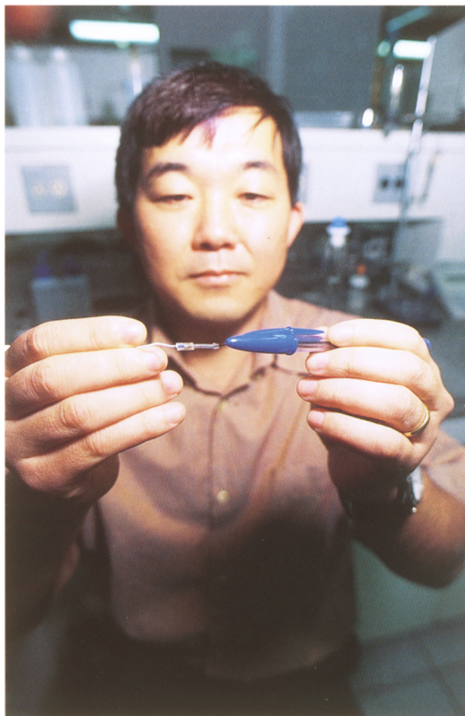
Lauro Kubota: biossensor de fibra de carbono com enzima imobilizada e estável, menor do que uma esterográfica
