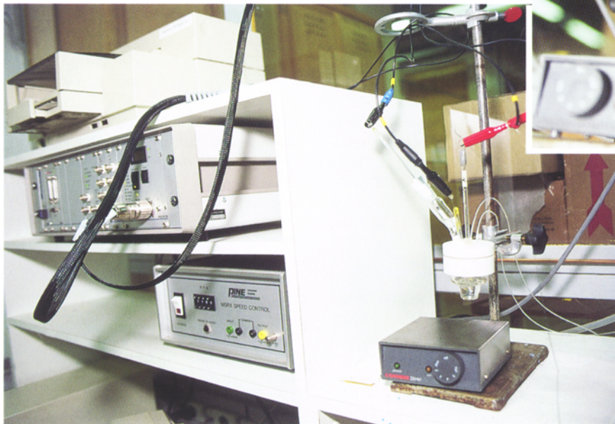
Em teste: os aparelhos registram os dados dos biossensores, formados por um eletrodo e um composto biológico, que encosta nos líquidos (no destaque)
