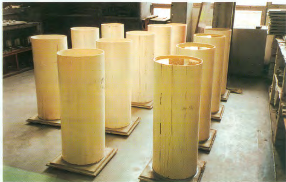
Os testes de retenção de umidade usam tubos com água sobre os corpos-de-prova
