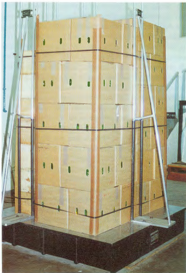
Mesa vibratória simula os movimentos de um caminhão
