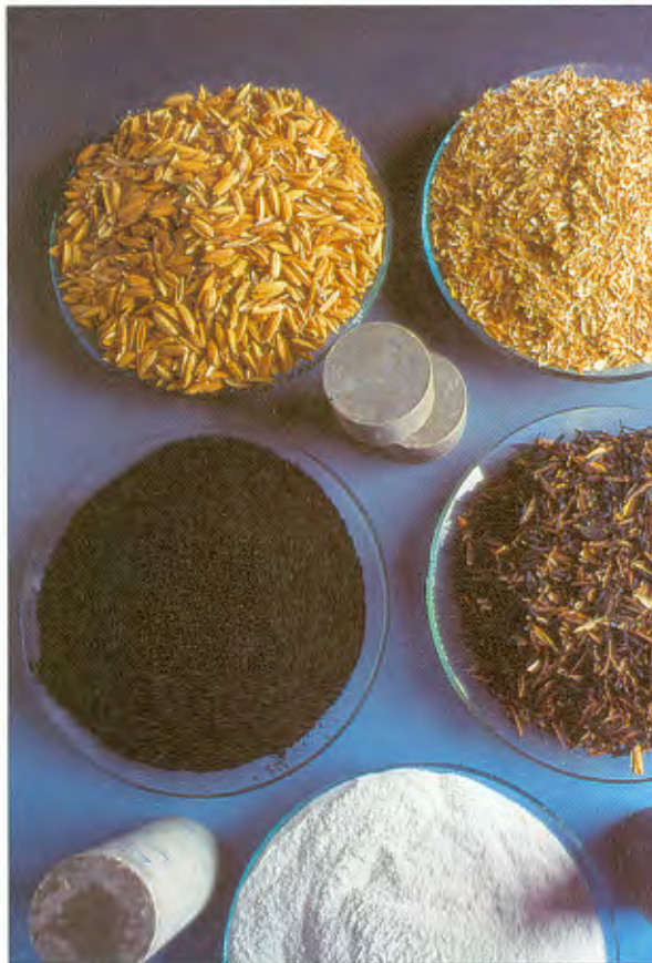
Fases da sílica: da casca ao pó branco e no concreto
