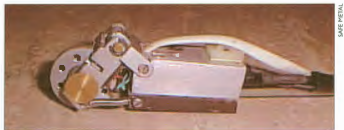
T-Scan: Aparelho emite ultra-som e analisa chapas de aço
