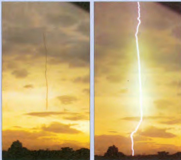
Foguete leva o fio de cobre através da atmosfera (esq.) e o raio desce por ele (dir.). O halo verde é o cobre evaporando
