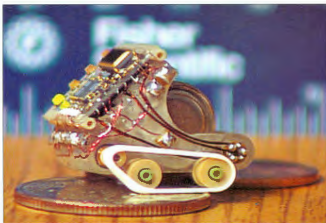
Esteiras e três baterias de relógio fazem o minirrobo se movimentar
