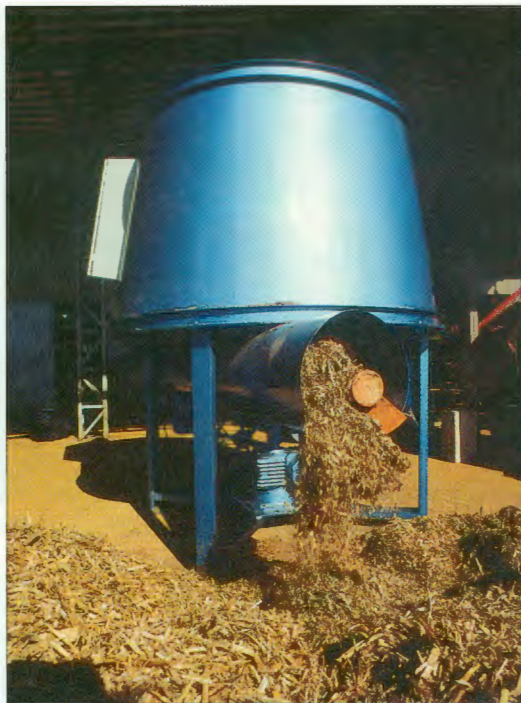
Unidade piloto: corte de base e despalhamento
