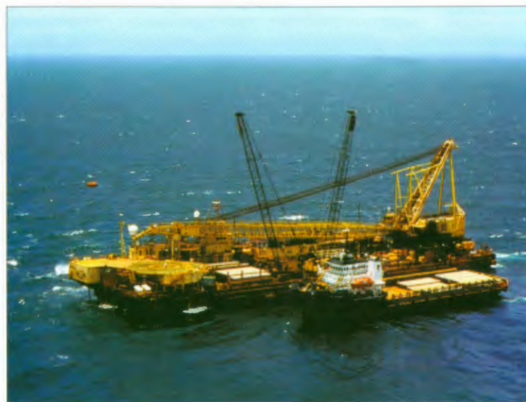
BGL-1: na nova configuração dinâmica, seis sistemas propulsores
