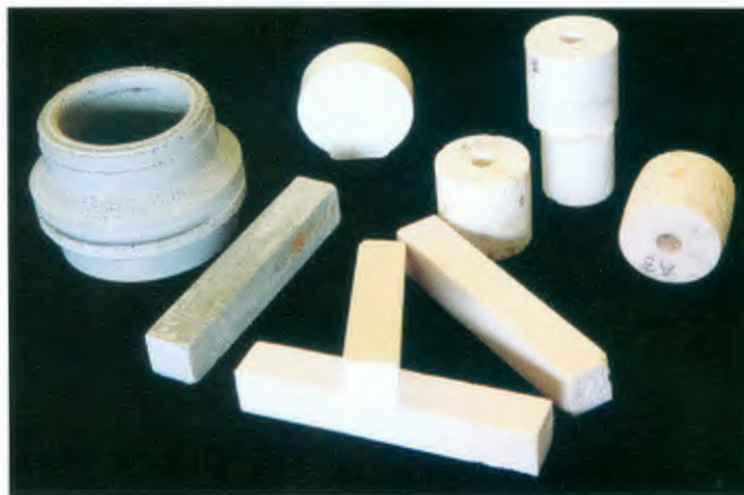
Refratários: corpos de prova feitos no laboratório da UFSCar
