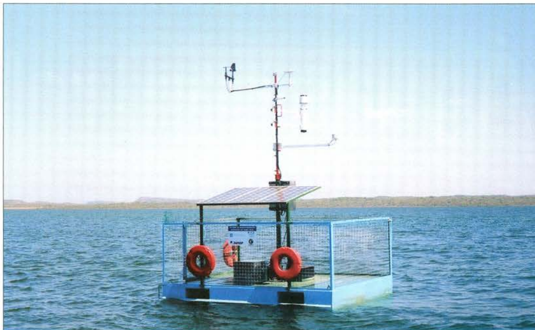
Plataforma estacionada na represa faz leituras em tempo real
