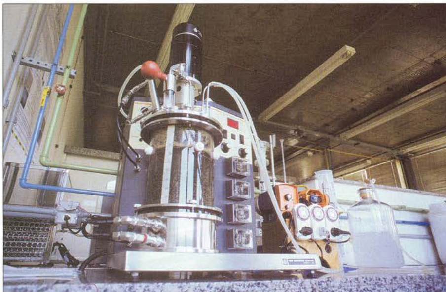
Reator anaeróbio na Mauá: estudo de tratamento de águas residuárias
