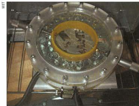
Lentes de acrílico são feitas com molde flexível
