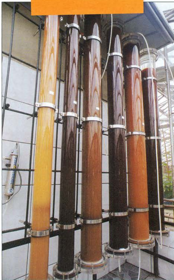
Colunas de acrílico usadas para produzir água desmineralizada pelo processo de troca iônica
