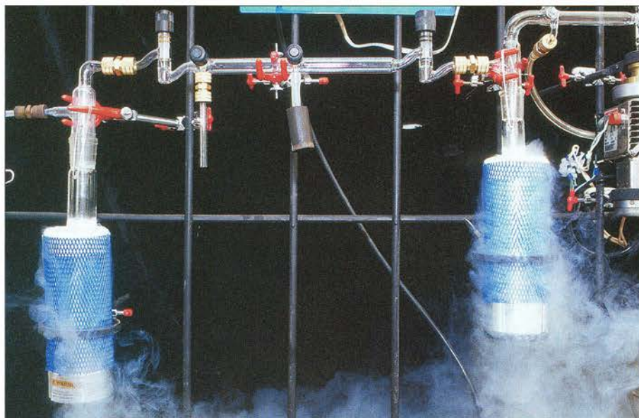
Equipamento usado para processamento de cobre. Com a adição de hidrogênio a 450 o C, retira-se oxigênio do metal
