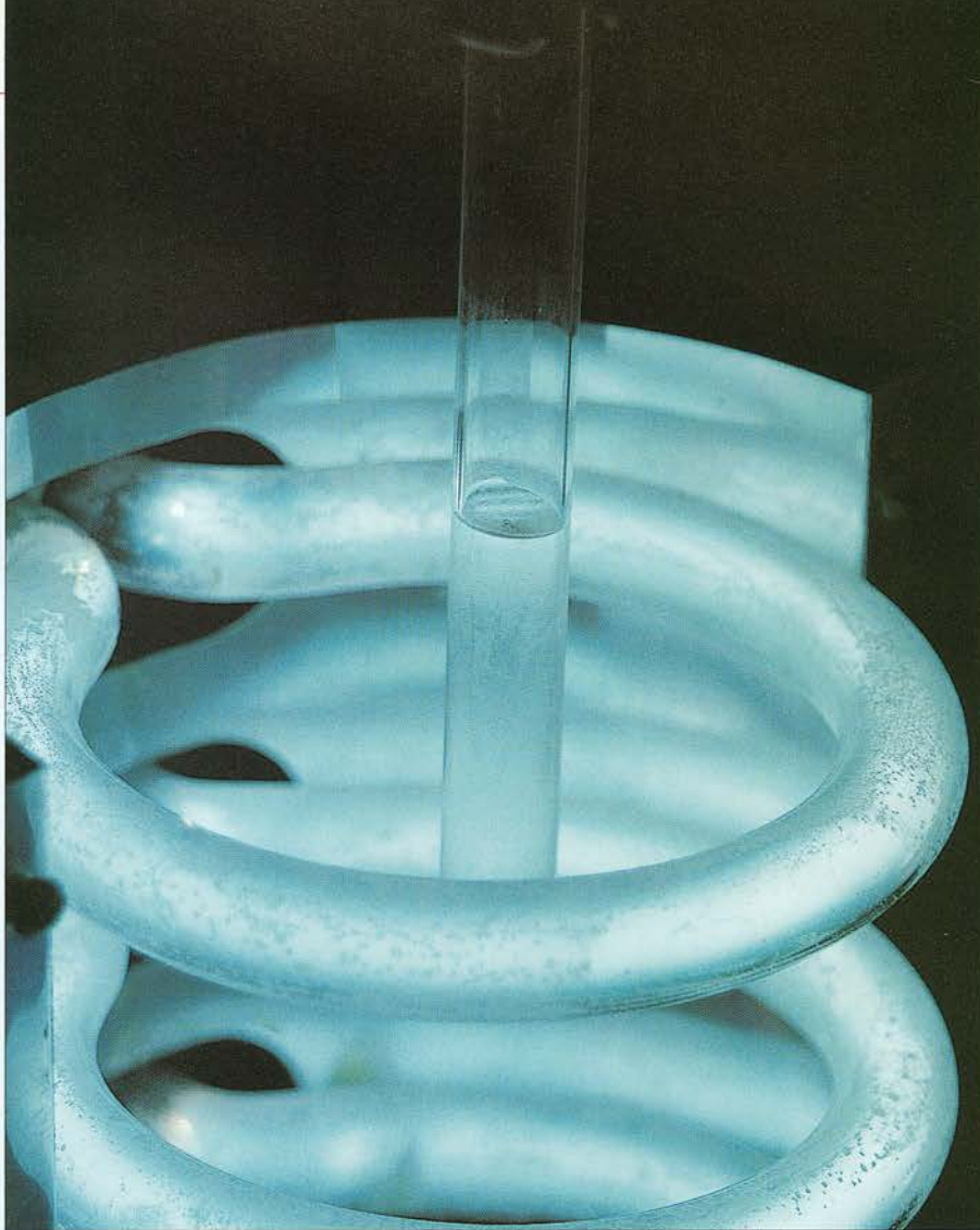
Produção de hidrogel, em laboratório, com radiação ultravioleta
