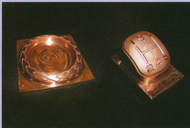
Coroa de louros e manopla de cobre: para gravar o molde
