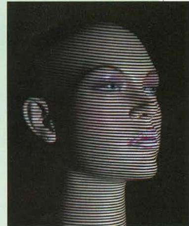
dos no banco de dados do computador. Para captar a imagem, são utilizadas uma câmera digital e uma lâmpada que funciona com uma espécie de rede sobre a fonte luminosa. A sombra da rede projetada sobre a face é deformada conforme o relevo do rosto. A partir das linhas da rede, um programa faz cálculos que fornecem o volume do rosto e o reconhecem numa fração de segundo. •
