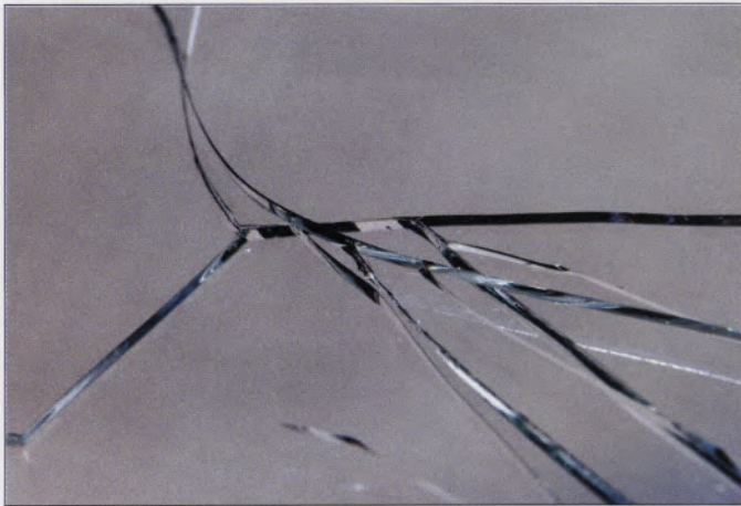
Vidro trincado: a fratura depende das áreas de tensão
