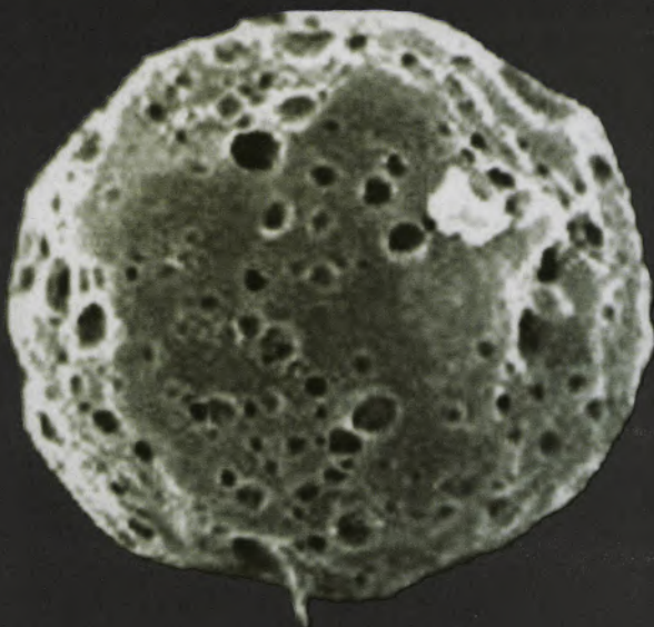
Microesfera com polímero degradado após 15 dias de liberação do fármaco
