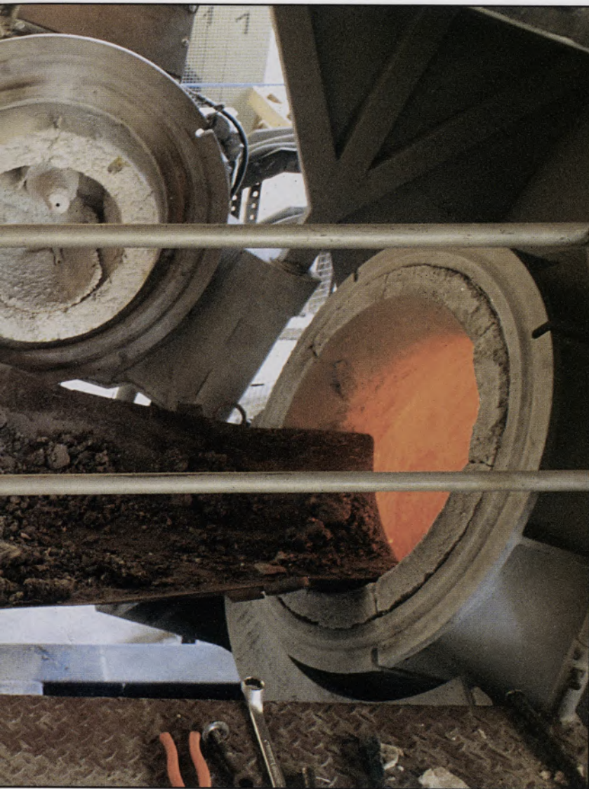
Forno no IPT: 50 toneladas de alumínio reciclado
