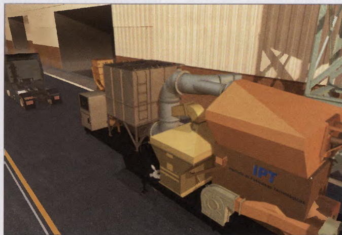
Miniusina: recicla areia usada na fundição de peças metálicas
