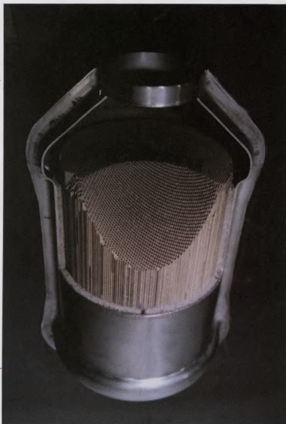
Equipamento instalado no catalisador melhora desempenho do sistema de descarga de gases dos automóveis
