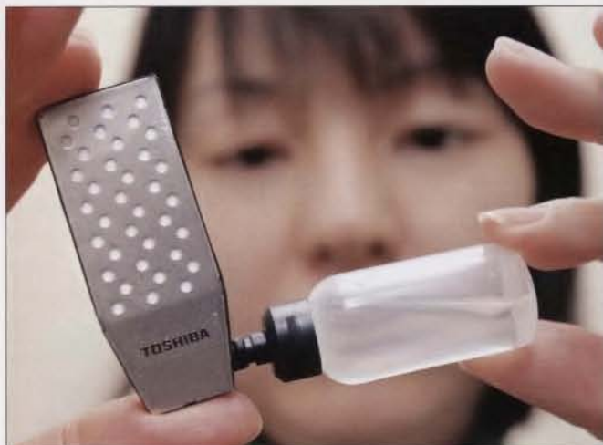
Bateria recebe recarga com metanol: prático e rápido
