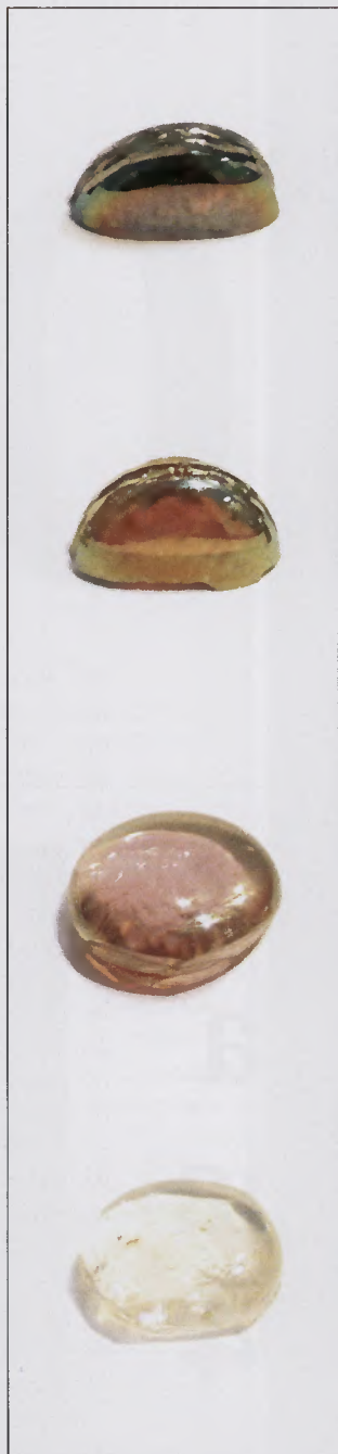
Vitrocerâmicas para uso em próteses: ação bactericida com prata
