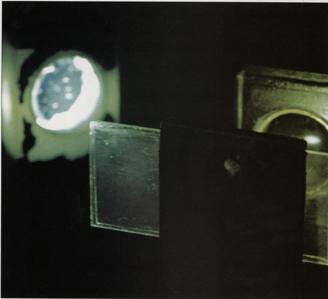
Interior da câmara do equipamento de fluoroimunoensaio: a lâmina de vidro vai receber o material a ser analisado e a luz ultravioleta
