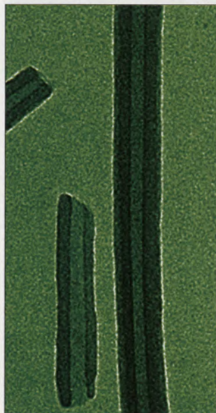
Nanotubo de porfirina: cobertura de platina
