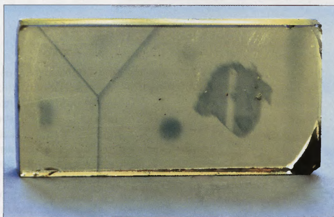
Armazenamento no vidro é feito por feixes de laser. Ao lado, a imagem de Albert Einstein gravada em uma amostra
