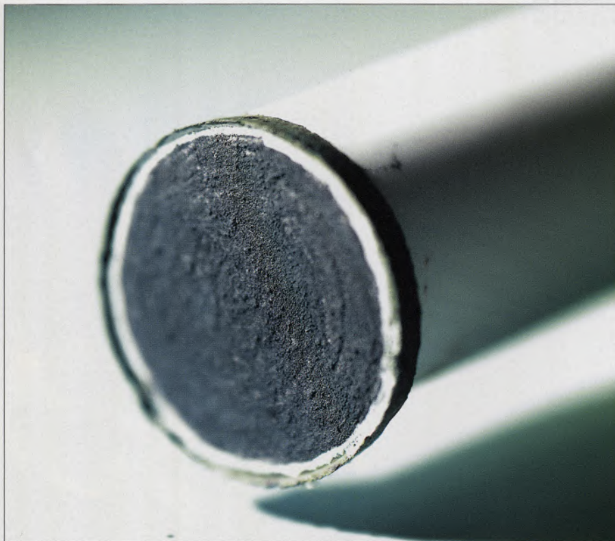
Célula redonda: o eletrólito é a camada branca, entre o catodo (cinza) e o anodo (verde)
