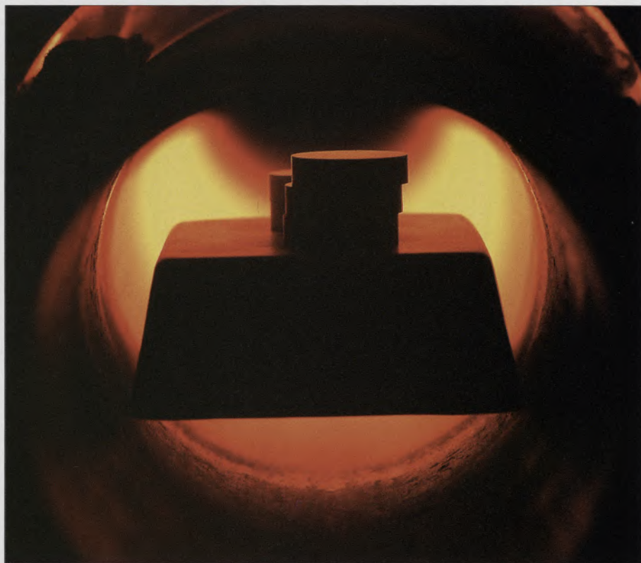
No forno, preparo de eletrólitos de cerâmica em forma de pastilhas
