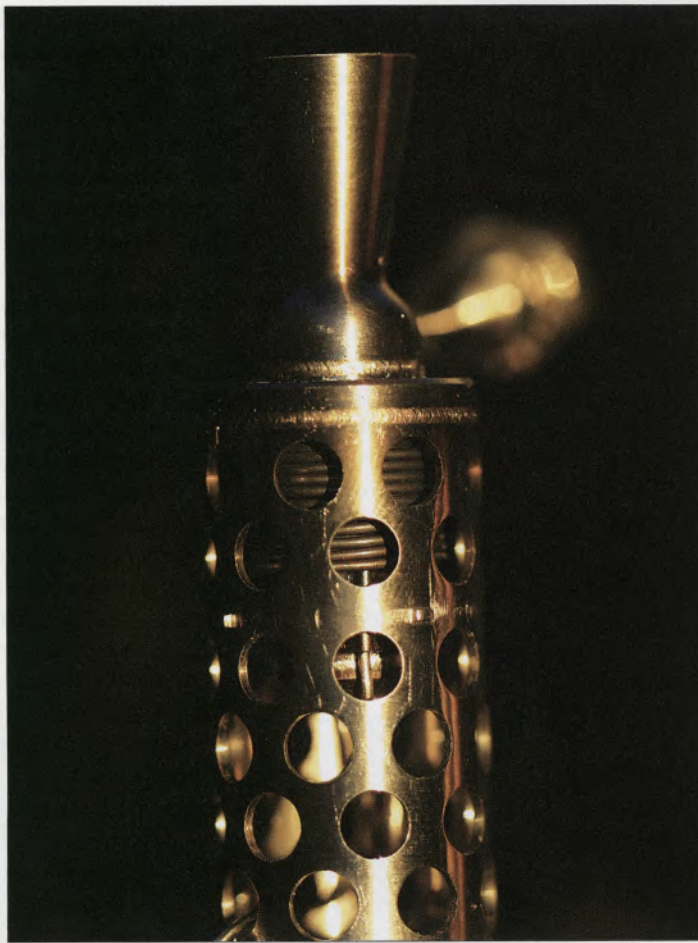
Propulsor: gases expelidos geram empuxo para manobras do satélite
