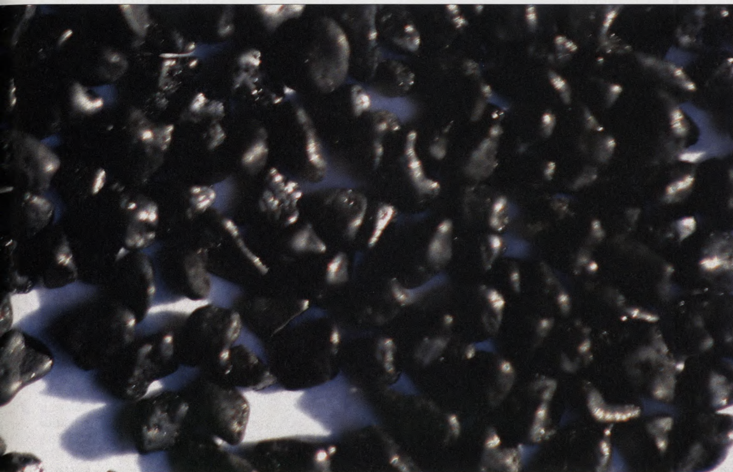
Grãos do catalisador, formados por alumina e irídio, que participam da queima do combustível
