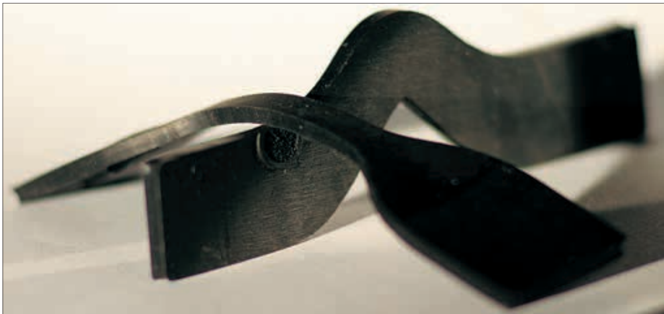
Testes avaliam a resistência da borracha dos corpos-de-prova ( acima ), feitos com um novo aditivo ( à esq. )
