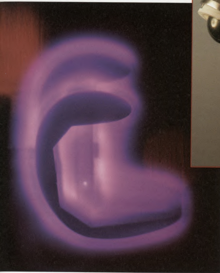
Prótese de joelho (à esq.) imersa no plasma e de quadril (acima) revestida com DLC
