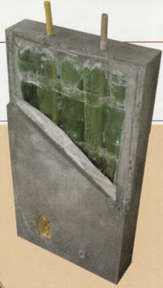
Casa é montada com painéis compostos de colunas verticais de garrafas e argamassa
