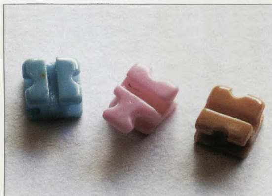
Cobre, ferro e níquel imprimem cores à alumina
