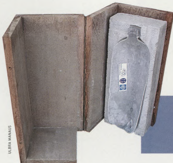
Fôrma de madeira usada para moldar tijolo feito de PET, cimento e areia
