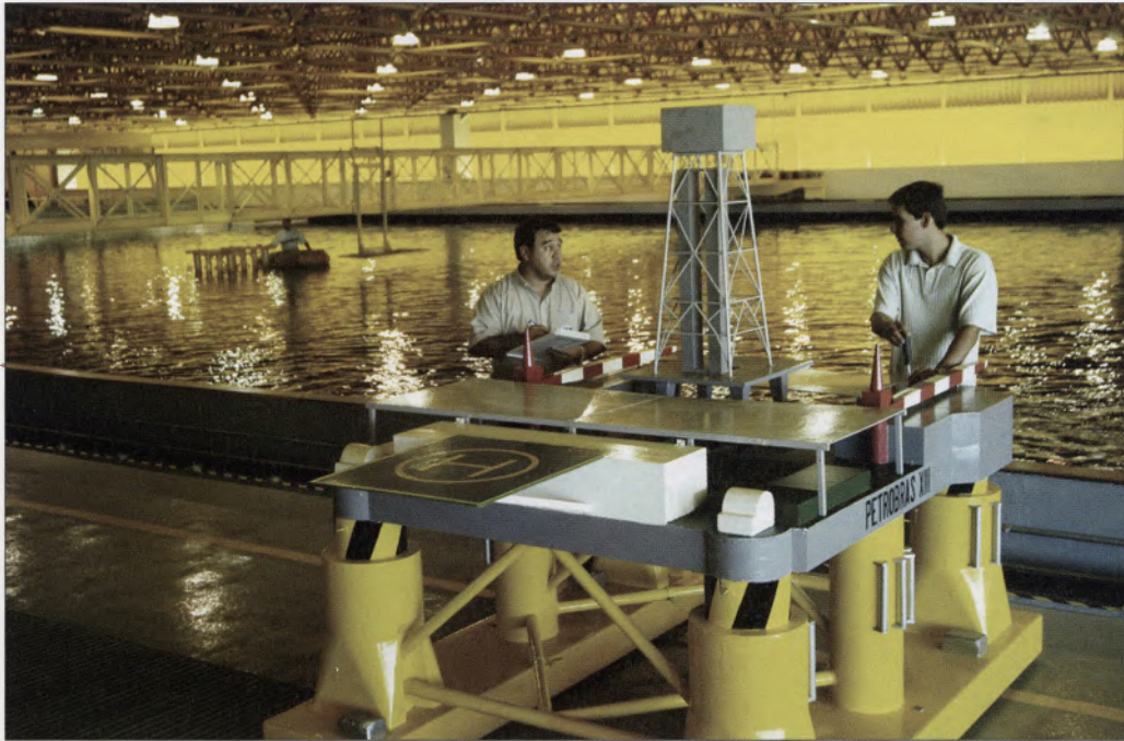
Tanque oceânico da UFRJ: pesquisa com maquetes de plataformas e de navios
