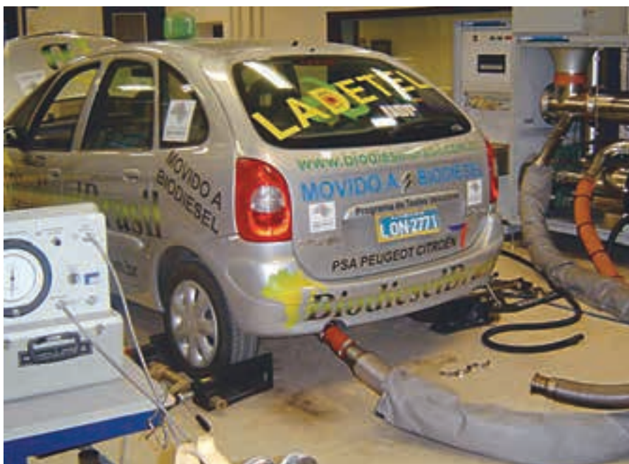
No Lactec, em Curitiba, testes de bancada para carro movido com 30% de biodiesel
