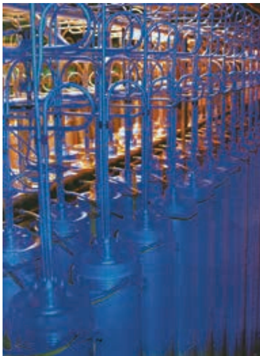
Ultracentrífugas de urânio produzem combustível para Angra I e II
