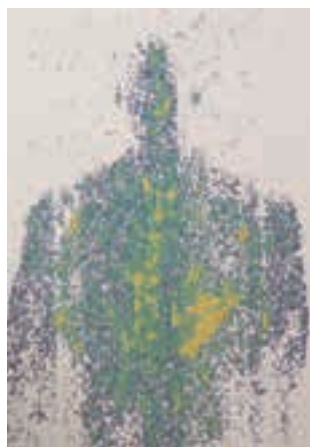
Imagem de raios T de manequim com roupa e material plástico no bolso
