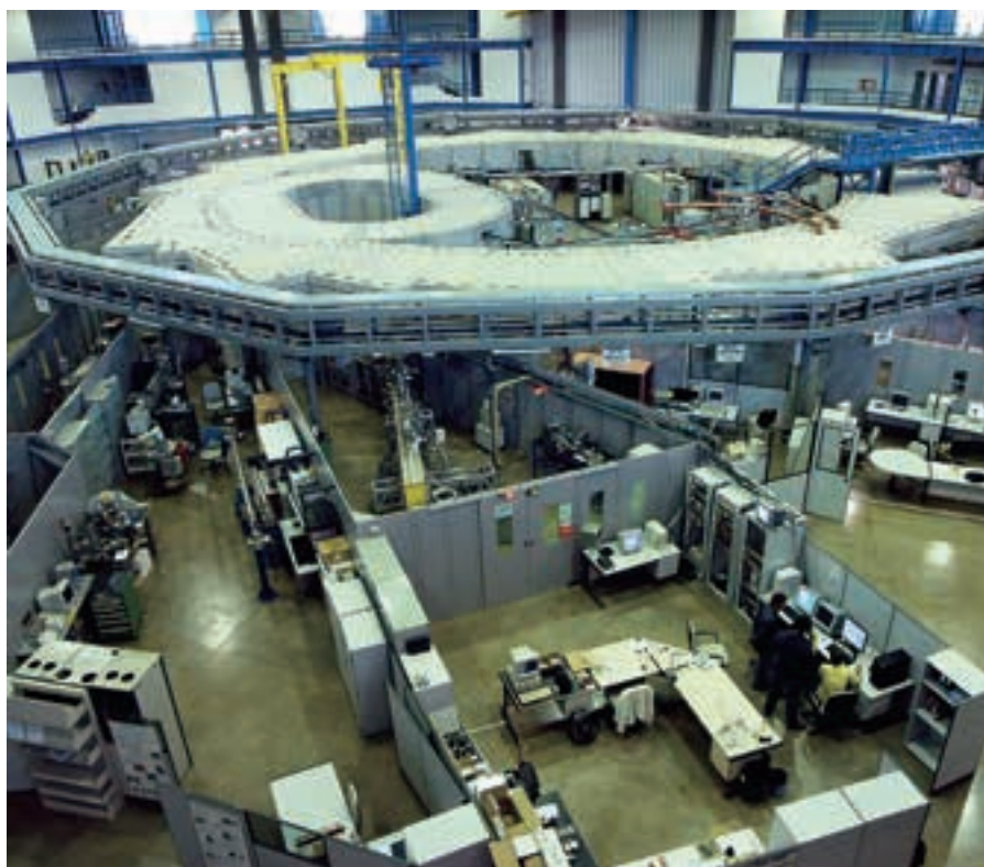
Anel de armazenamento do síncrotron tem 90 metros de circunferência
