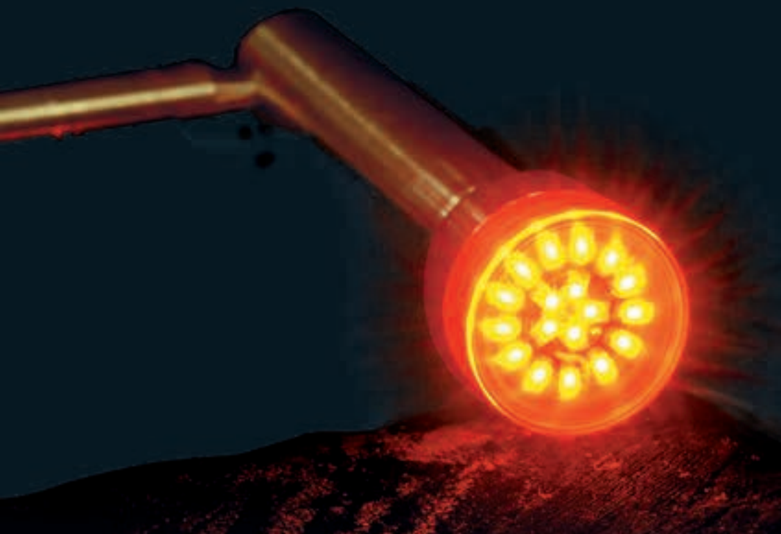
Aparelho substitui o laser em terapia fotodinâmica para tratamento de câncer de pele
