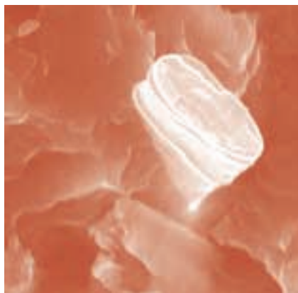
Adesão da fibra no material vista com microscópio eletrônico de varredura
