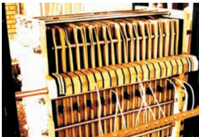
Metais ficam retidos em uma esponja de carbono poroso
