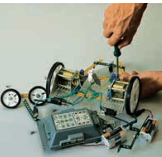
O conjunto do Kit Alfa possui um módulo de controle, estruturas para montagem, além de rodas que formam um robô...
